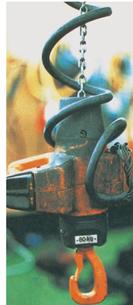
Bild 4-3: ... ein aus der Einführung herausgerutsches Zuführkabel oder defekte Zugentlastung, darf er den Kran nicht in Betrieb nehmen
