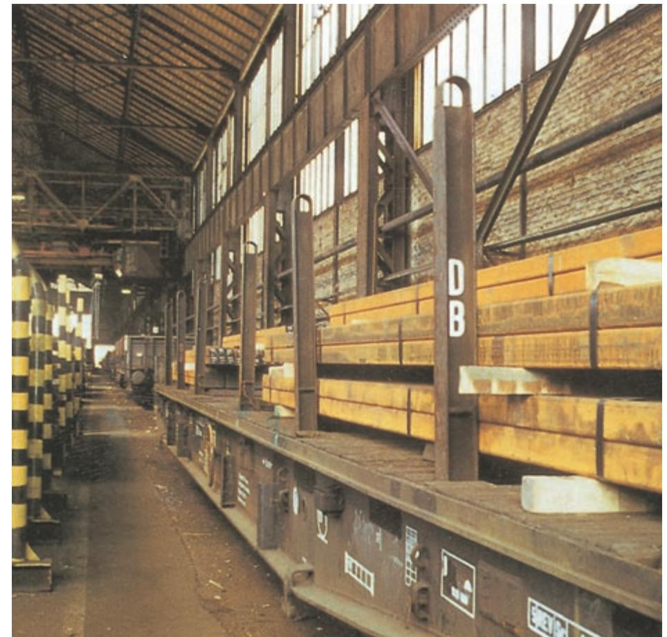
Bild 5-21: Ordnungsgemäß beladener Eisenbahnwaggon
