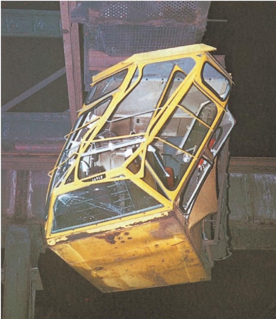
Bild 4-6: Bei der Langfahrt stieß die Unterkante des Führerhauses seitlich an zu hoch gelagertes Material
