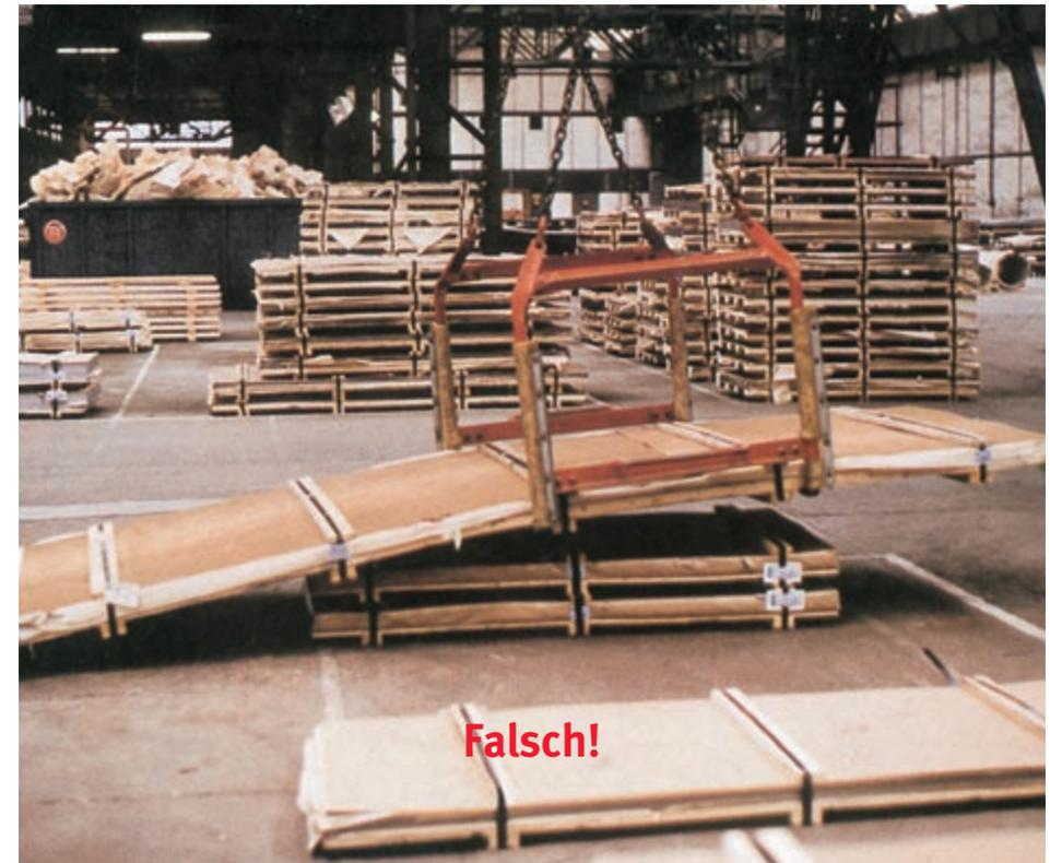
Bild 5-19: Derart schräg hängende Lasten sind sofort wieder abzusetzen, damit die Aufhängung korrigiert werden kann
