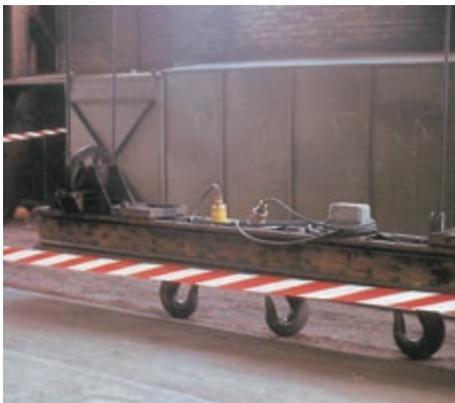
Bild 9-1: Der Gefahrenbereich unter dem Kran ist durch rot-weißes Flatterband abgesperrt
