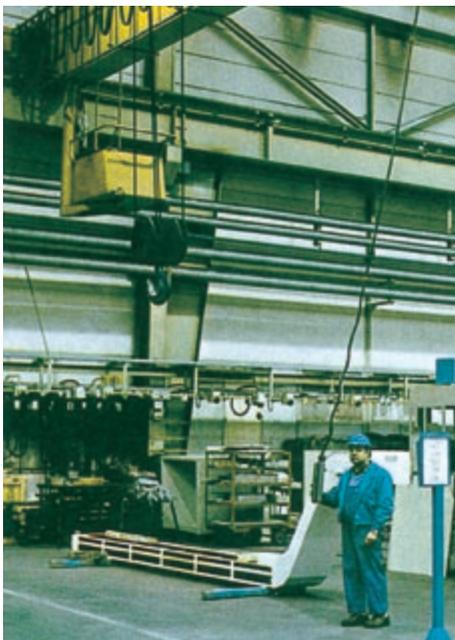
Bild 3-1: Krananlage, die wahlweise entweder vom Führerhaus oder von Flur aus gesteuert werden kann
