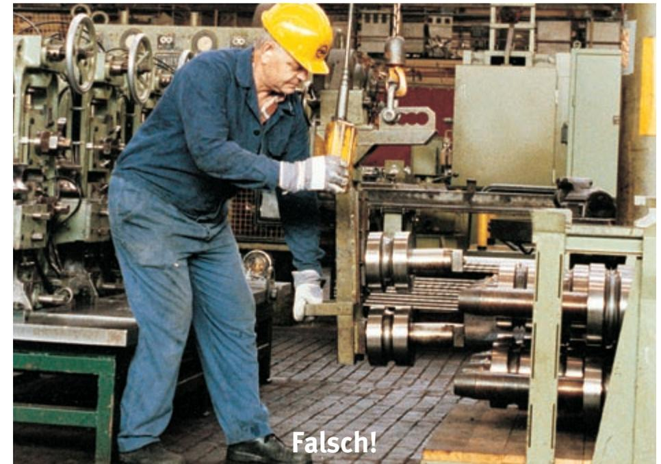
Bild 5-23: Der Kranführer darf sich nie vor der Last aufhalten und durch Drücken versuchen, die Last abzubremsen
