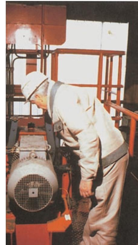
Bild 4-5: Der Kranführer prüft den ordnungsgemäßen Zustand einer Kupplung
