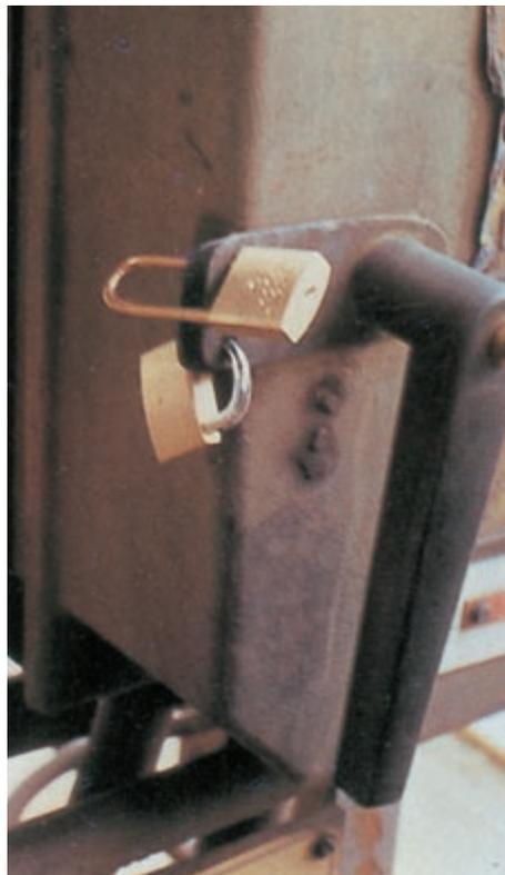
Bild 8-1: Der Trennschalter ist ausgeschaltet. Durch die Vorhängeschlösser, für die nur die auf dem Kran Arbeitenden die Schlüssel haben, ist das irrtümliche oder unbefugte Einschalten verhindert.
