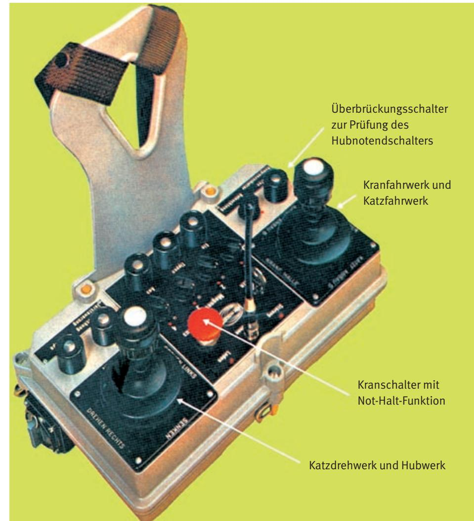
Bild 3-4: Steuergerät einer Funkfernsteuerung mit Zuordnung der Stellteile. Zur Sicherung gegen unbeabsichtigtes Betätigen sind die Stellteile mit einer Sensortaste ausgerüstet; möglich sind z. B. auch Schutzbügel oder vertieft angeordnete Stellteile (siehe auch Bild 4-9 auf Seite 27)
