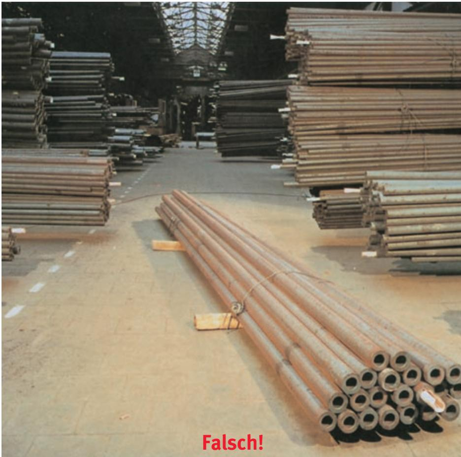
Bild 5-22: Lasten ragen in den markierten Verkehrsweg. Eine Last ist sogar hier abgesetzt
