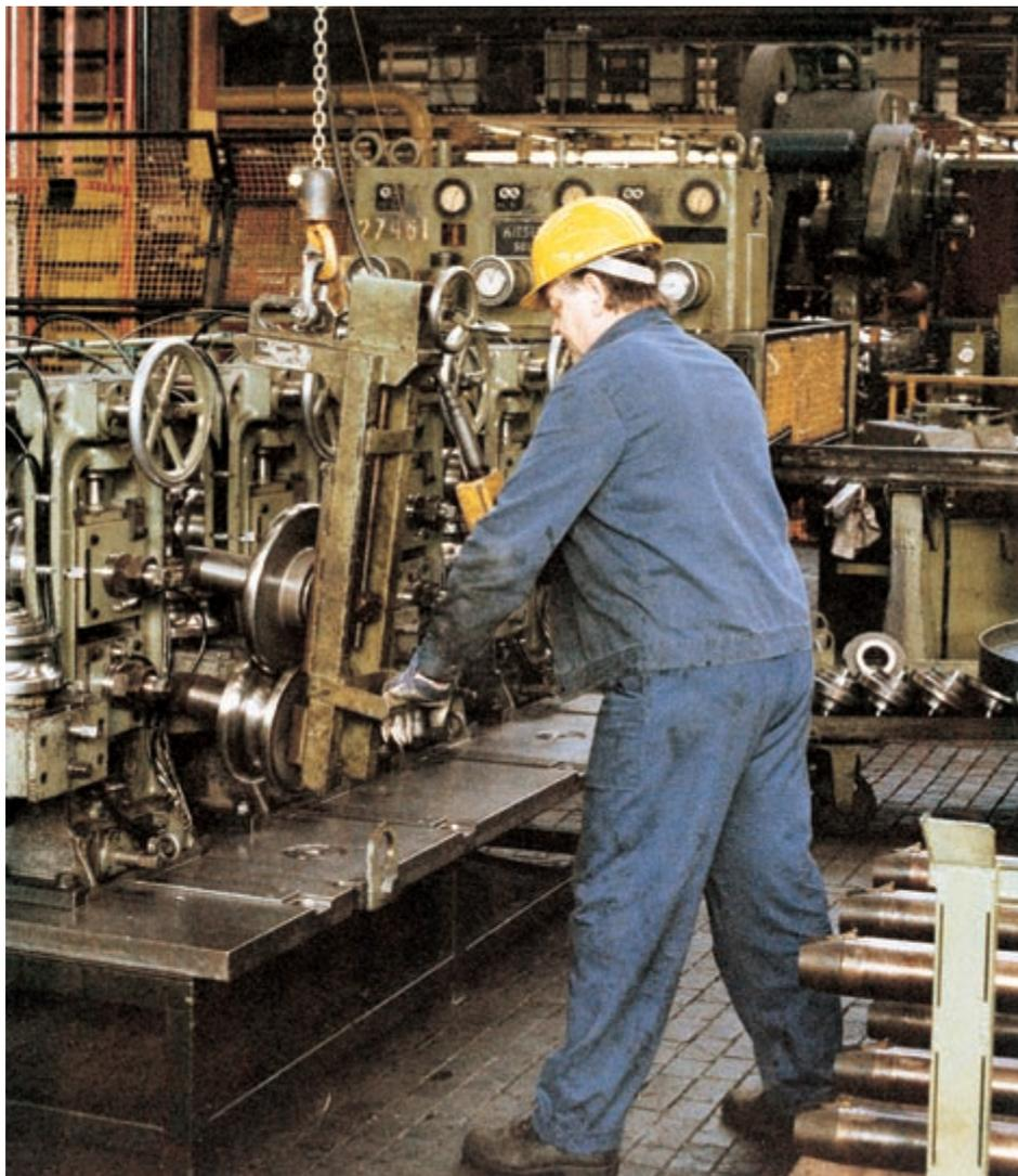
Bild 5-24: Der Kranführer befindet sich hinter der Last und bremst die Fahr- und Schwenkbewegung ziehend ab
