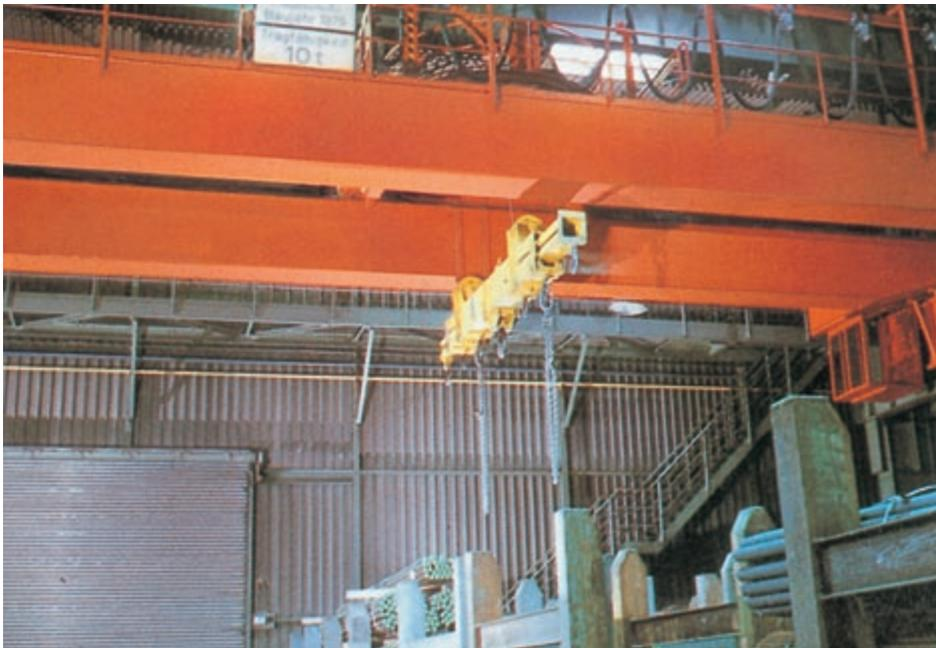
Bild 7-1: Der Kran ist an das Hallenende gefahren, die Traverse ist hochgezogen, die Ketten sind hochgehängt
