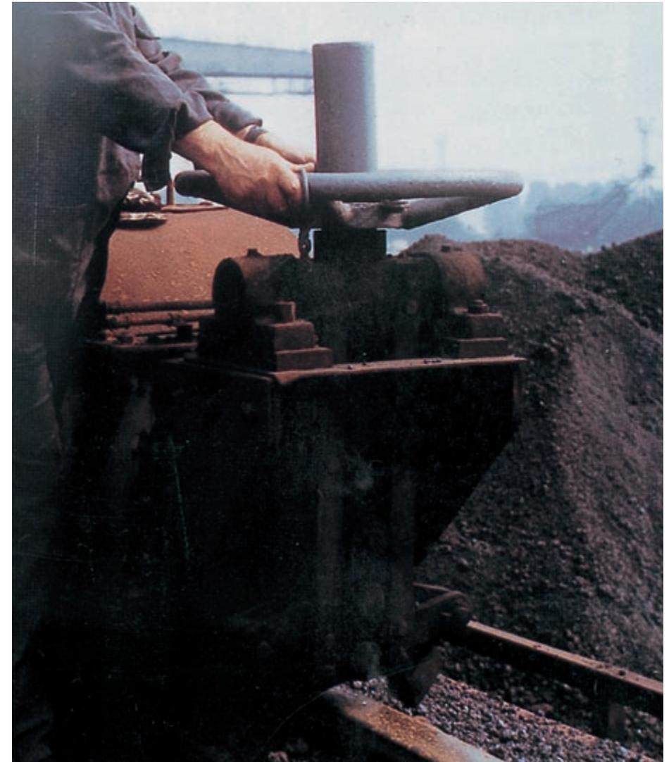
Bild 7-5: Der Kranführer der Verladebrücke dreht die Schienenzangen an. Diese Windsicherung kann an jeder Stelle der Kranbahn betätigt werden
