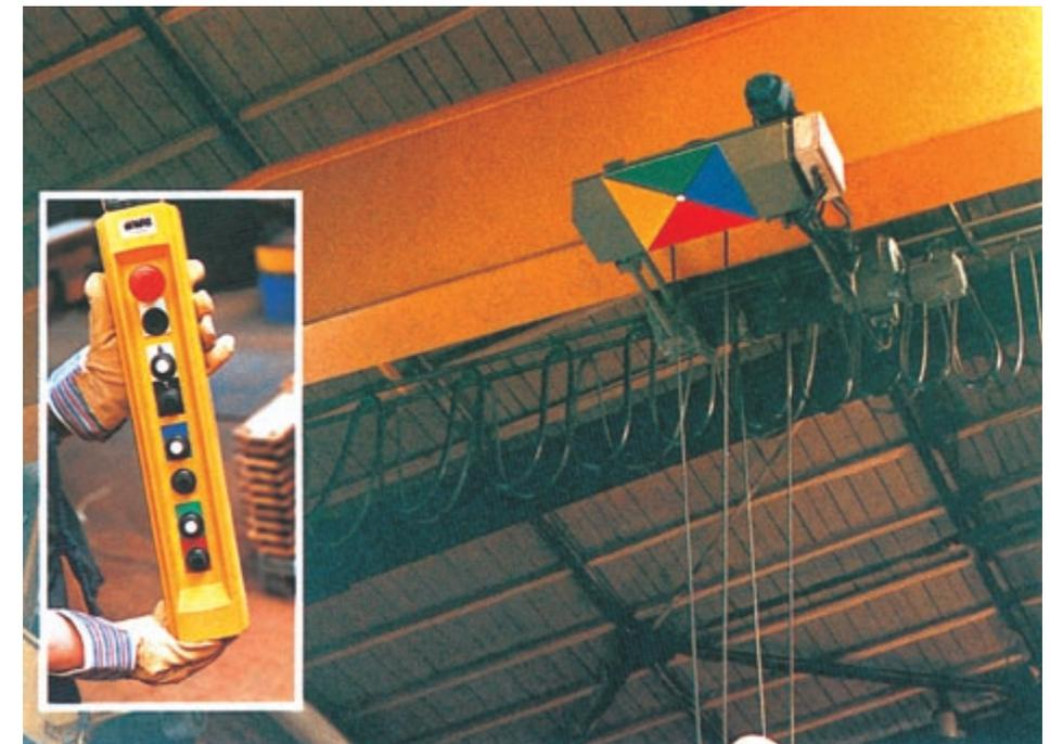
Bild 3-6: Richtungsangaben an Kranbrücke oder Steuertafel durch unterschiedliche Farben oder Zeichen ermöglichen auch dem Ortsunkundigen eine eindeutige Richtungsbestimmung
