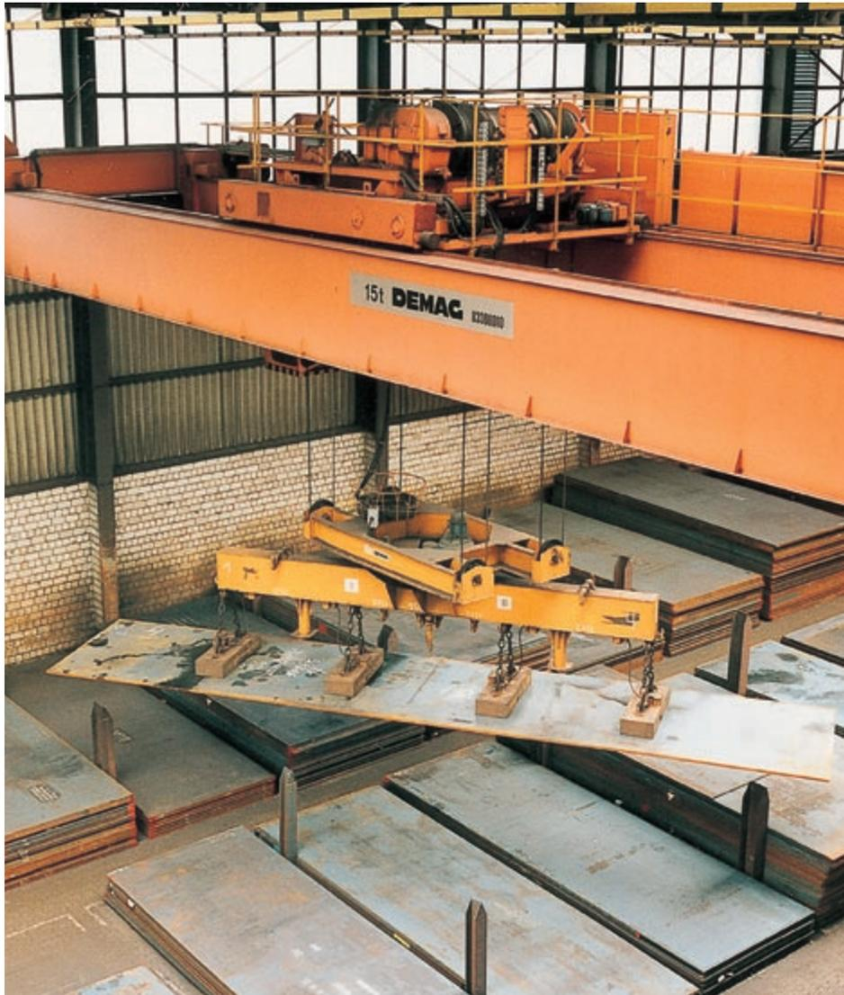
Bild 5-2: Traverse mit Magneten beim Transport von magnetisierbaren Stahlblechen
