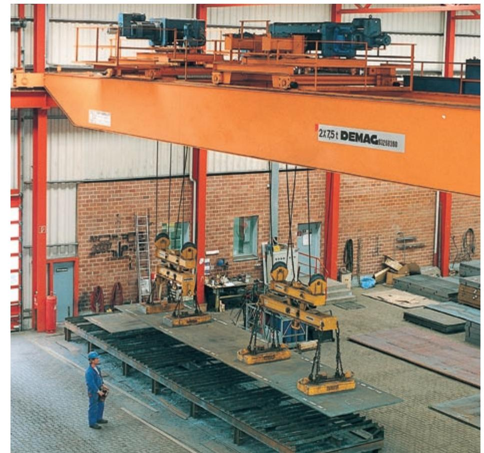
Bild 5-5: Der Kranführer steuert den Kran aus sicherer Entfernung zur Last, die nur durch Magnetkräfte gehalten wird
