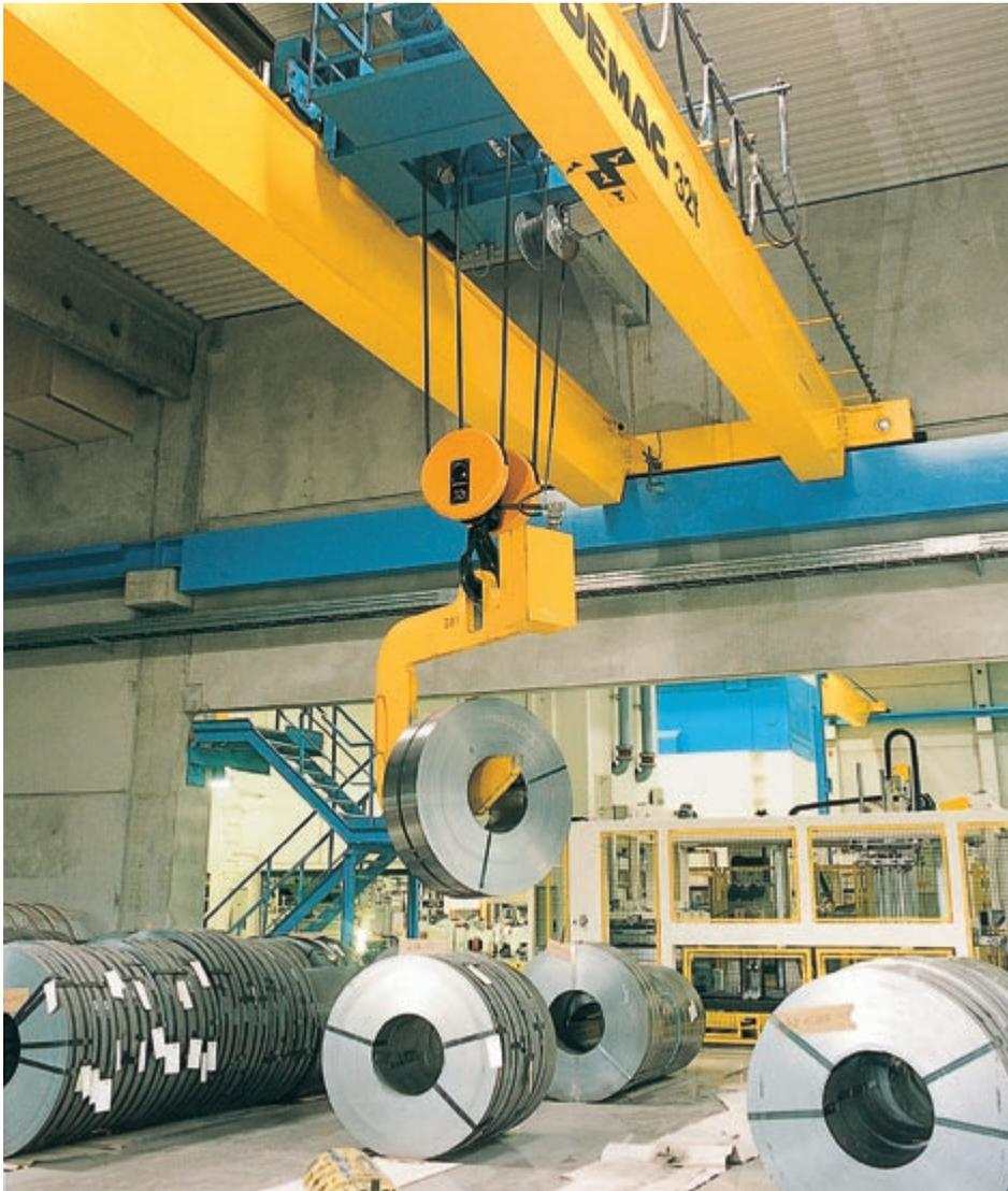
Bild 5-8: Aufnahme des Coils im Coilauge durch C-Haken
