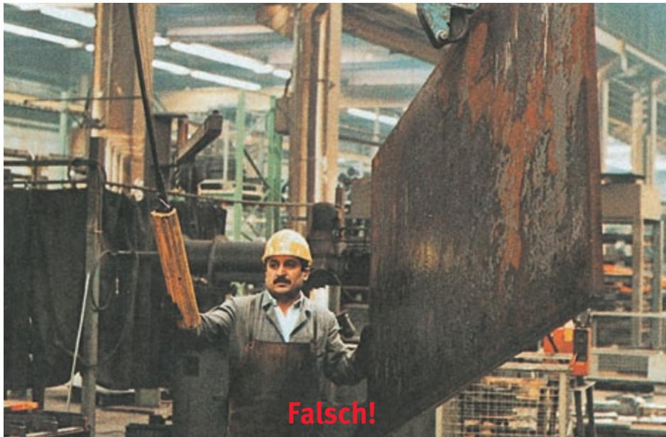
Bild 5-6: Der Kranführer ist stark gefährdet, wenn er sich in unmittelbarer Nähe von Lasten aufhält, die nur kraftschlüssig – in diesem Fall mit einer Blechklemme – gehalten werden
