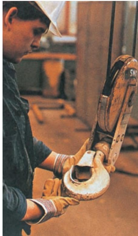
Bild 4-10: Der Kranführer kontrolliert das Hubseil und die Unterflasche einschließlich des Kranhakens auf augenfällige Mängel
