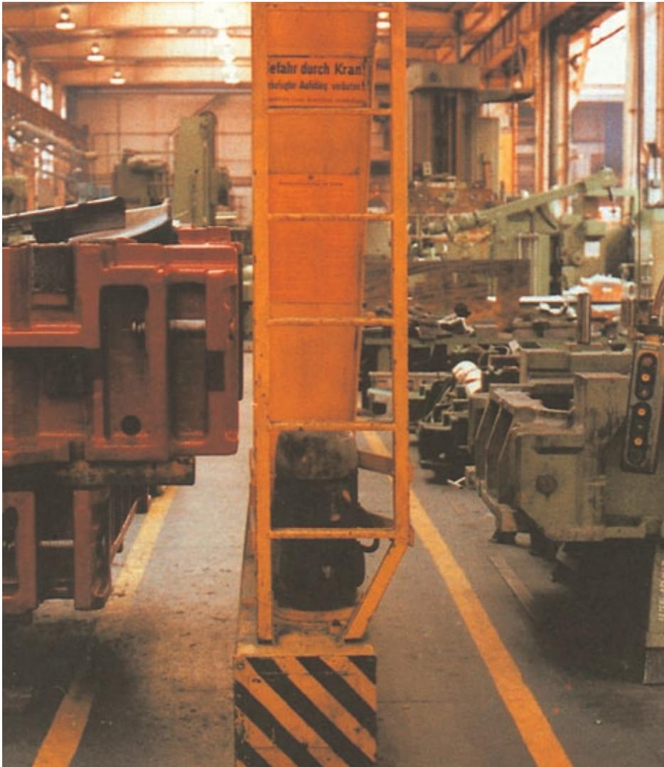
Bild 4-8: Es besteht **Quetschgefahr**. Der Kranführer erkennt dies rechtzeitig, wenn er vor Arbeitsbeginn einen Blick längs der Kranbahn wirft
