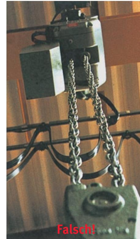
Bild 4-11: Ein Blick in Längsrichtung der hängenden Hubkette genügt, um festzustellen, dass die Kette verdreht ist
