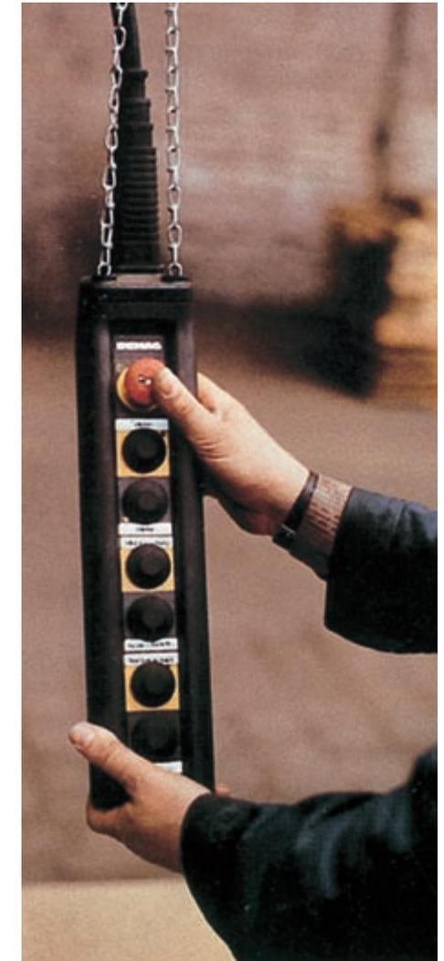
Bild 7-3: Bei fluggesteuerten Kranen wird der Kranschalter durch Drücken des auch als „Not-Halt-Schalter“ bezeichneten roten Pilztasters betätigt
